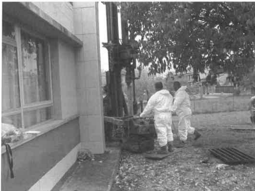
Foto 1: sondaggio stratigrafico
