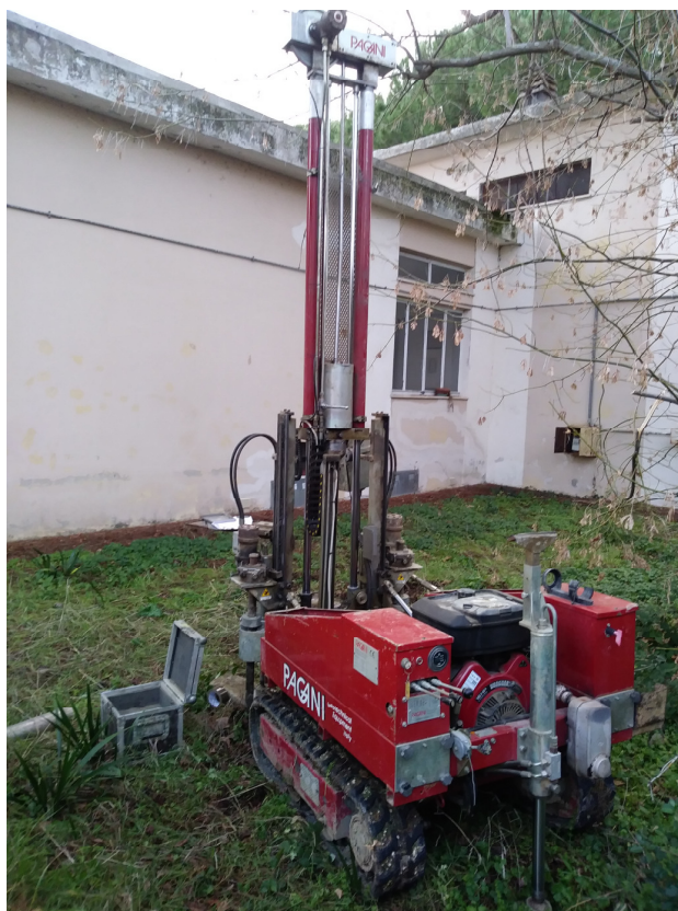
foto 2: esecuzione prova CPT1
