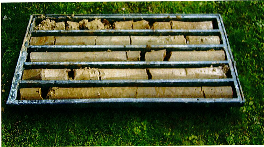
Fotografia 3 - Stratigrafia S1 da -5.00 a -10.00 m
