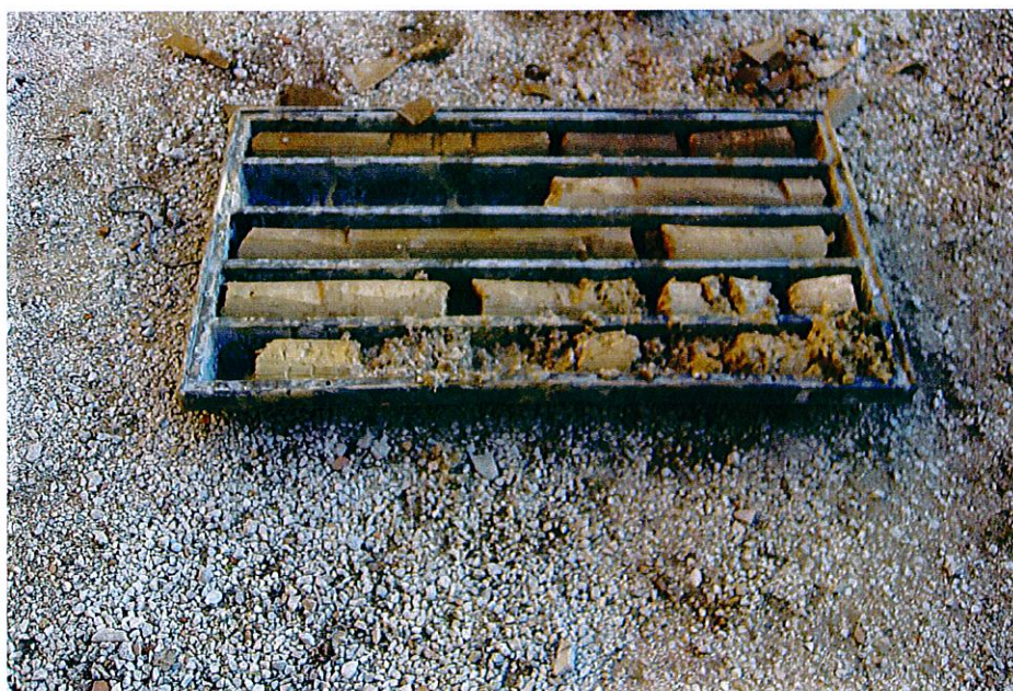
Fotografia 8 - Stratigrafia S2 da -5.00 a -10.00 m da - 6.00 a -6.50 campione indisturbato
