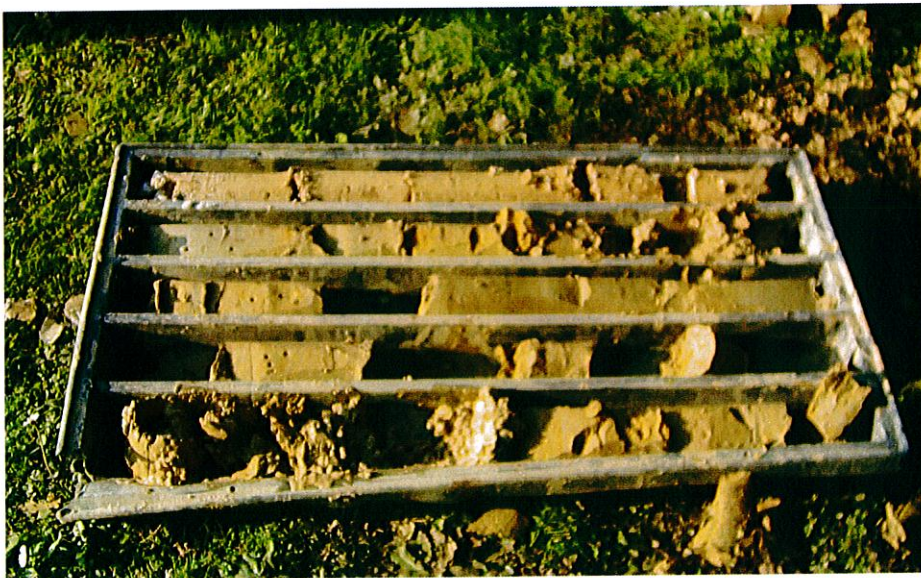
Fotografia 4 - Stratigrafia S1 da -10.00 a -15.00 m da -11.00 a -11.45 m SPT
