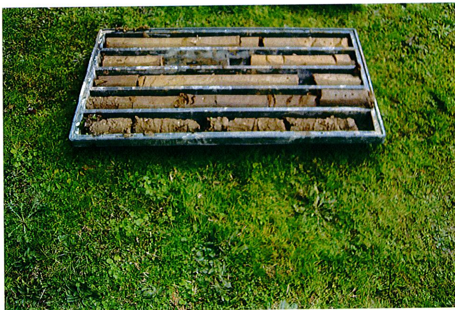
Fotografia 2 - Stratigrafia S1 da 0.00 a -5.00 m da p.c., da - 3.20 a -3.60 campione indisturbato
